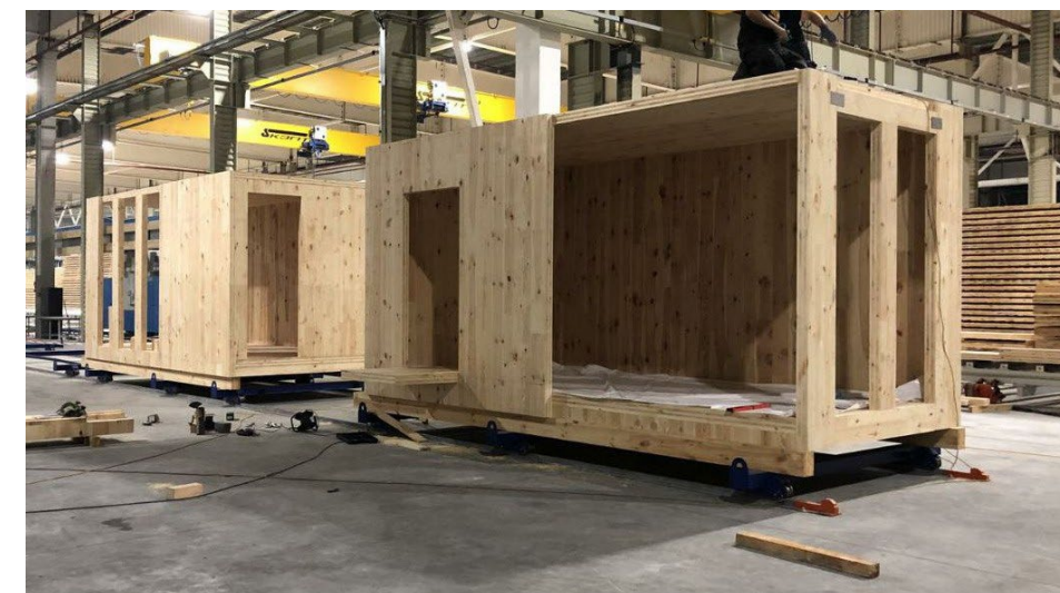
Модулі CLT виробляються на заводі в м. Коростень, Житомирська область
