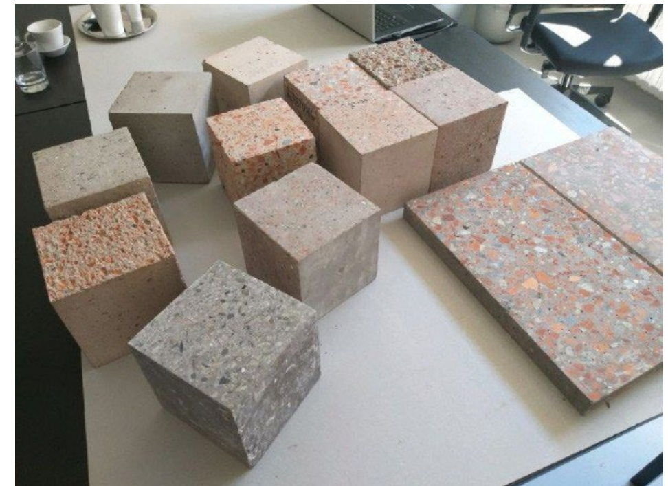
Зразки матеріалу під назвою "Rebetong", зробленого зі змішаних РЗ. Джерело: skanska.cz
